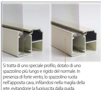
Guida con sistema antivento (brevetto internazionale Bettio)
